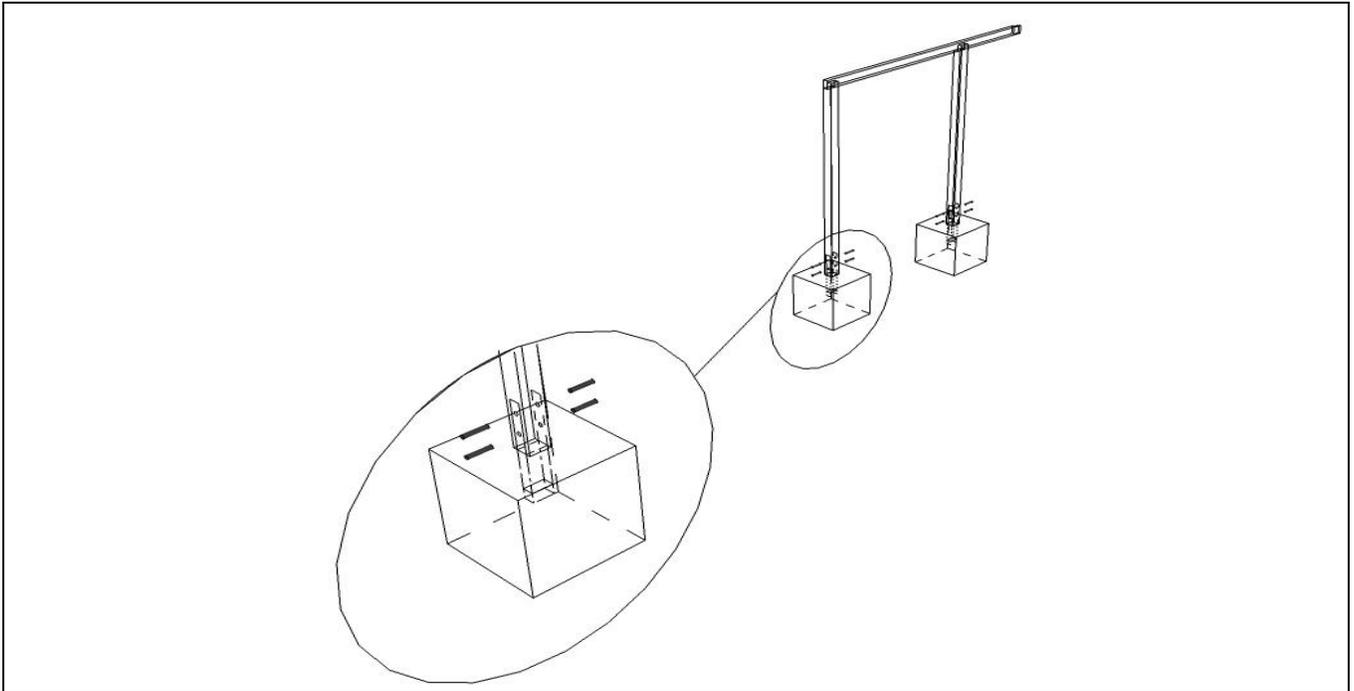
Placez les 3 poteaux (pièces A) d'un côté en alignement. Tendez un cordeau passant par les 3 poteaux. Le cordeau doit être tiré à l'horizontale environ à 10cm au dessus du sol.
