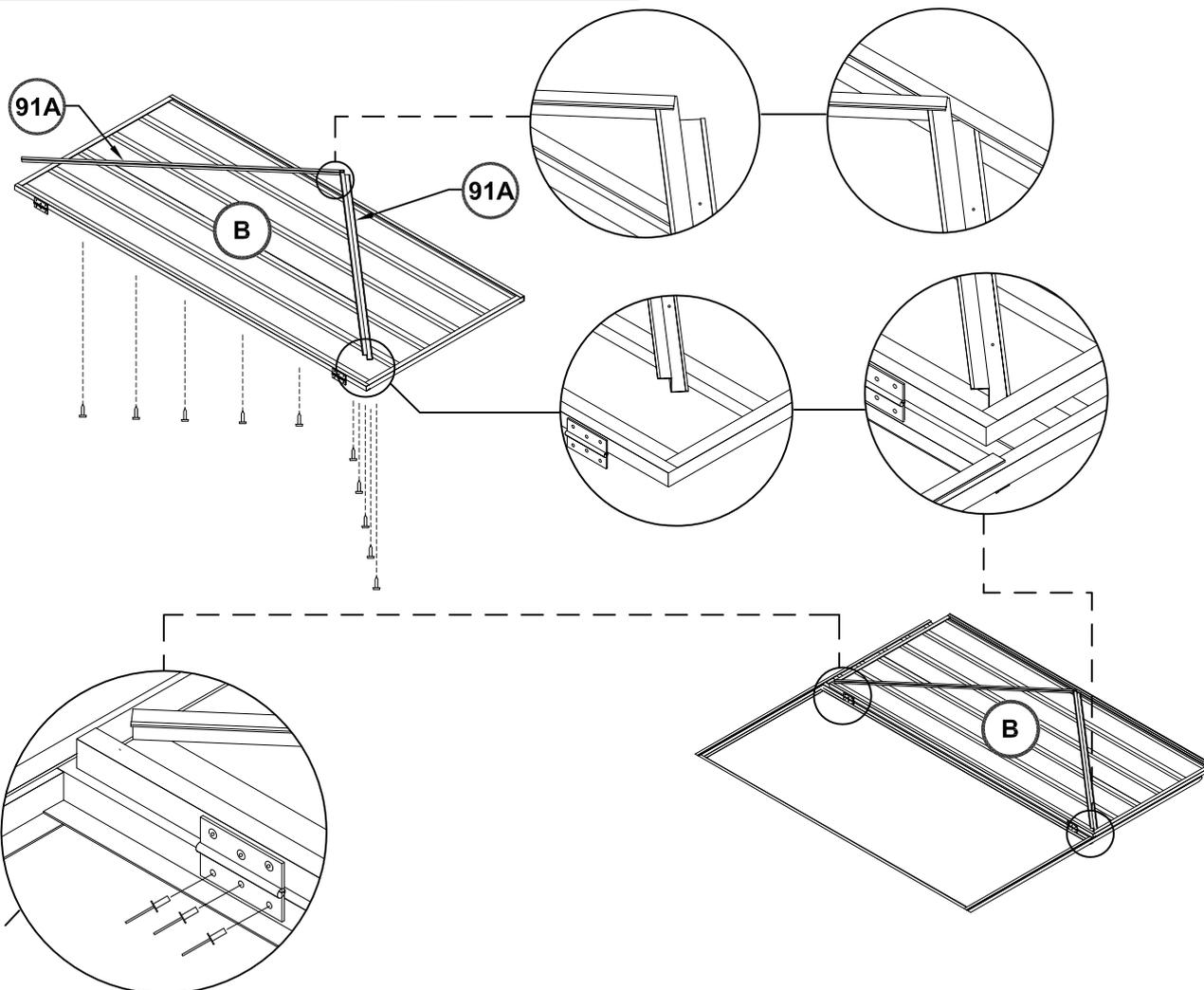
← REMARQUE : il est possible d'utiliser des écrous et boulons (fournis) à la place des rivets pop (fournis). Pour cela, il faut agrandir les trous de fixation des charnières qui se trouvent sur le montant à l'aide d'un foret de 4mm.
