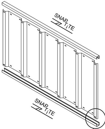
Afin de préassembler les quatre panneaux de paroi et les deux panneaux de toiture, les profilés en U s'enclenchent en haut et en bas de chacun des panneaux à l'aide du système Snap Tite, tel qu'illustré sur les pages suivantes lorsque vous verrez le symbole:
