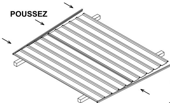
Après avoir assemblé les tôles, placez le profilé en U à une extrémité des tôles, puis tapez doucement dessus afin de l'enclencher, de part et d'autre de la tôle.
