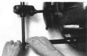
**6. mettre les roues en place(1). Insérer une rondelle (10) de chaque côté et bloquer avec les clavettes(11).**
