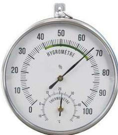
Cet appareil mesure simultanément l'hygrométrie (humidité) et la température de l'air ambiant.
